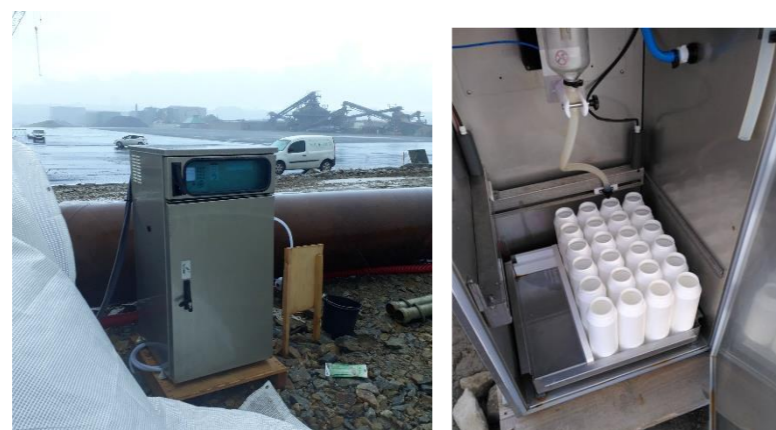
Figure 9 : Exemple de préleveur automatique 7 j – Source SDI/IDRA - PDPB
